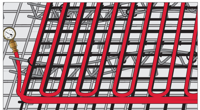
Рис. 8-28 Шаг 4: Произвести испытания сжатым воздухом
