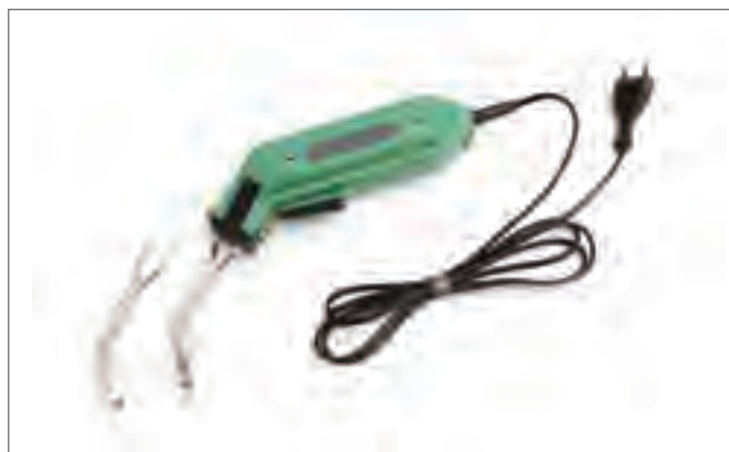
Рис. 3-55 Прибор для вырезания канавок
